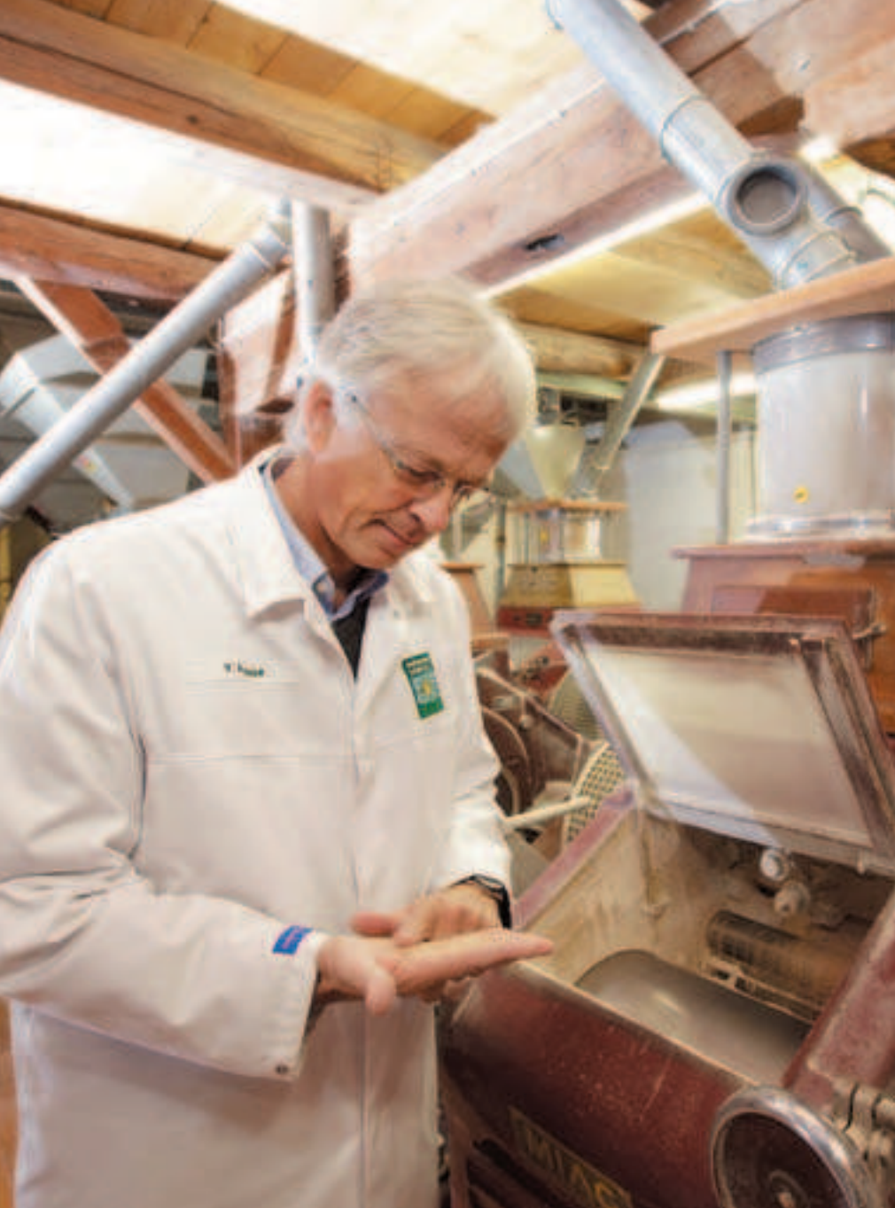
Aufwendig: In 14 hintereinander geschalteten Passagen zerkleinert die Mühle das Korn. Je nach Granulation wird es sortiert. Rund 7.000 Tonnen Mehl mahlt die Bohlsener Mühle jedes Jahr.
