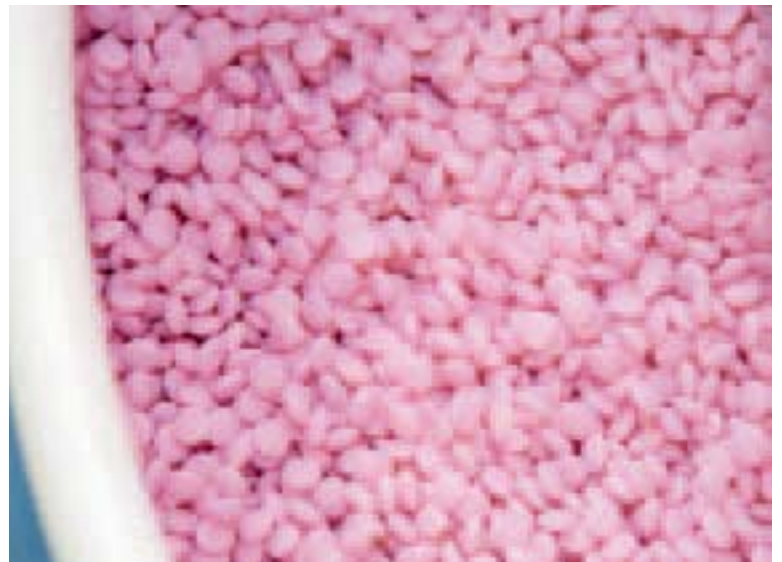
Echte Handarbeit: Den Dragees wird regelmäßig Zucker zugegeben, um eine gleichmäßige Schutzschicht aufzubauen. Ein aufwendiger und teurer Prozess – drei Tage lang bleiben die rosa Arzneien in Bewegung.
